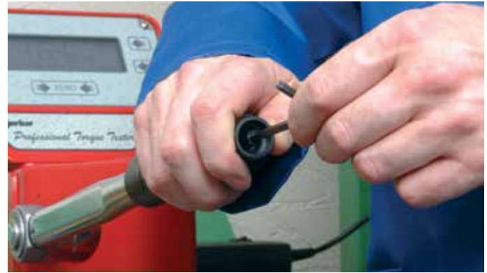
Einstellen eines Drehmomentschlüssels des Typs ,P'
